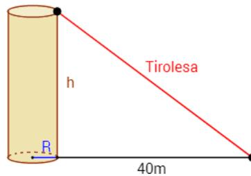
Tenemos un triángulo rectángulo de base 40m cuya hipotenusa coincide con la tirolesa. La altura de la columna,  $h$ , la podemos calcular a partir de su área lateral y su radio,  $R$ .
